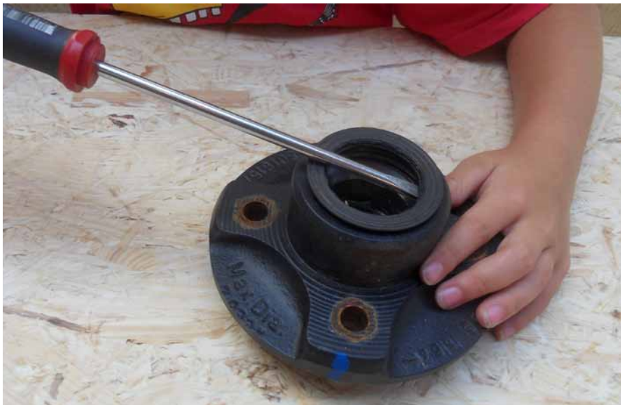
Fig. 37: Remove the seal
