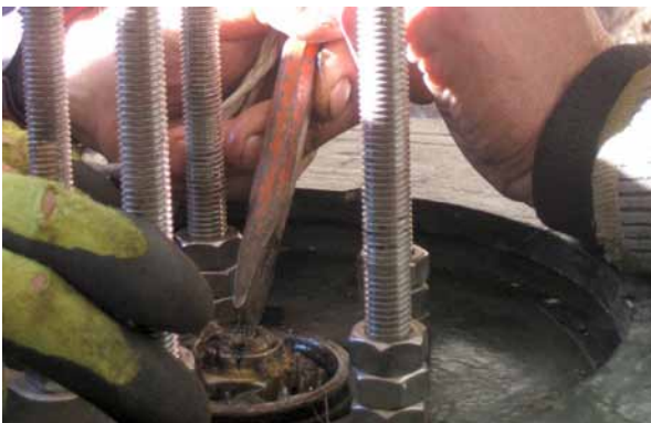
Fig. 41: Lock the nut
